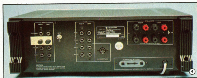
1) Gli indicatori di picco sono a sensibilità fissa, con scala molto ampia. 2) Il selettore tape consente di riversare dal registratore A al B (non viceversa) mentre si ascolta un'altra sorgente. 3) I transistor finali sono in contenitore plastico. 4) Tra le prese ce n'è una a norma DIN per il secondo registratore. 5) I grossi radiatori dei finali sono indipendenti per i due canali. 6) L'interno è ordinatissimo; quasi tutte le schede sono dietro i pannelli frontale e posteriore.
